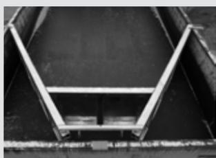
① 板をセットする（この時荷台と金具のセンターを合わせる）
